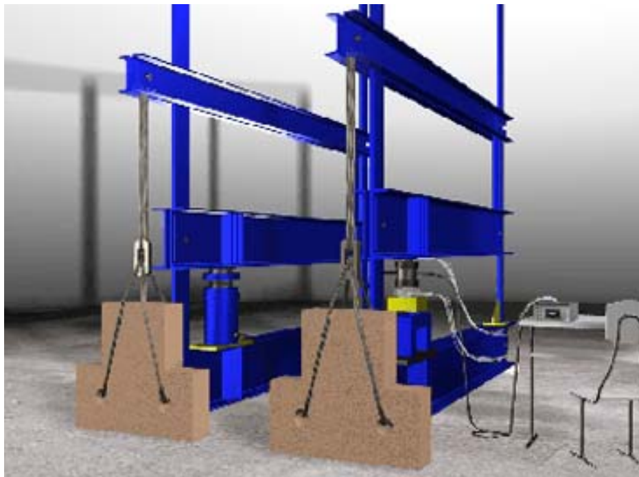
Slika 5. Aparatura za triaksijalni test Figure 5. Three-axial compression test apparatus
