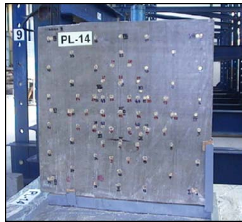
Slika 9. Pločasti uzorak: a) šema mjernih mjesta; b) uzorak za kompenzaciona mjerenja Figure 9. Plate specimen: a) layout of measuring points; b) specimen for compensation measurements
